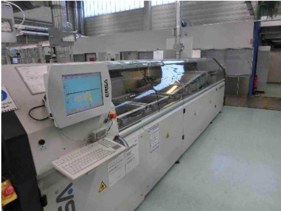
**Abbildung 4-7:** Wellenlötanlage der Firma Ersa [firmeninterne Fotografie]
