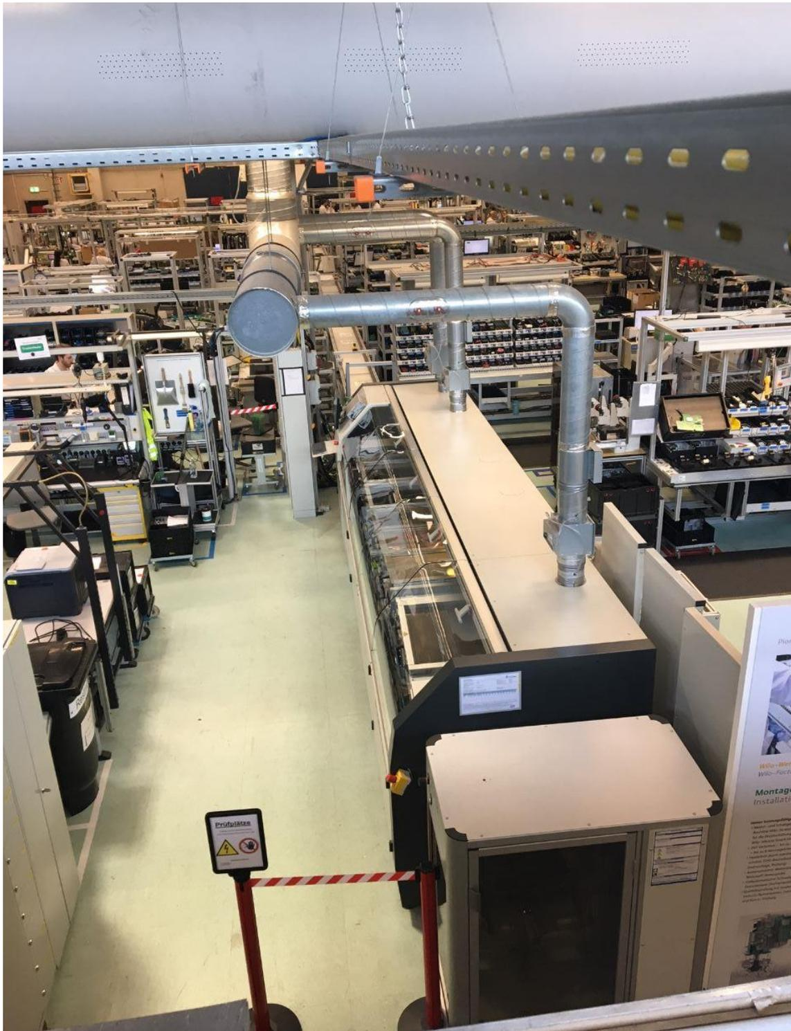
**Abbildung 5-2:** Lötanlage 2 mit Fertigungszellen
