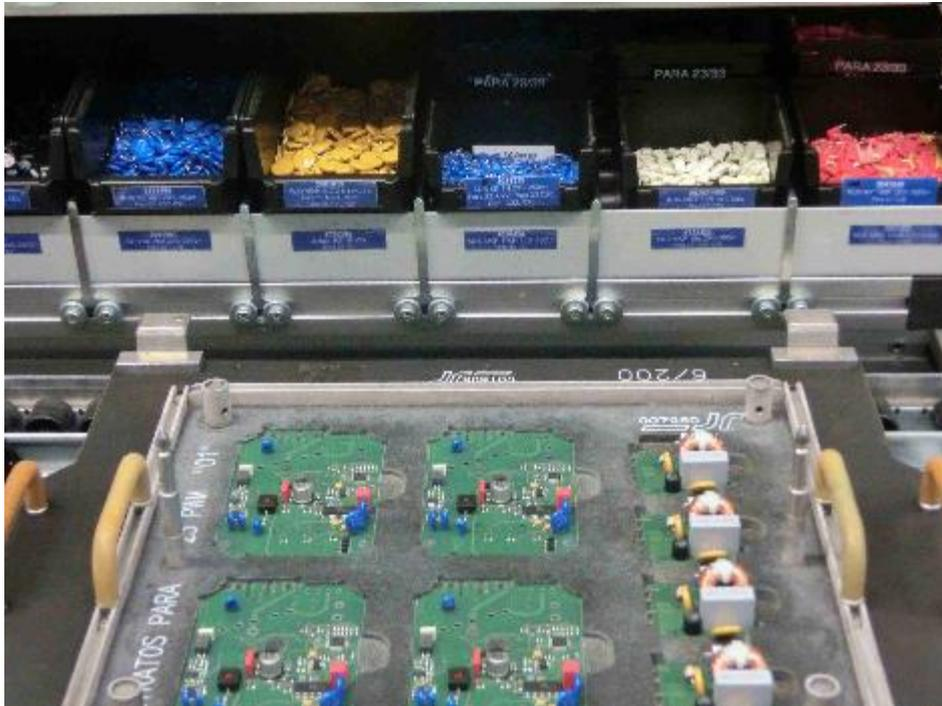
**Abbildung 4-6:** Leiterplatten in einem Lötrahmen bei der THT-Bestückung [firmeninterne Fotografie]
