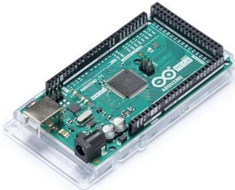
**Abbildung 3.6: Arduino Mega 2560 (Arduino 2020)**
