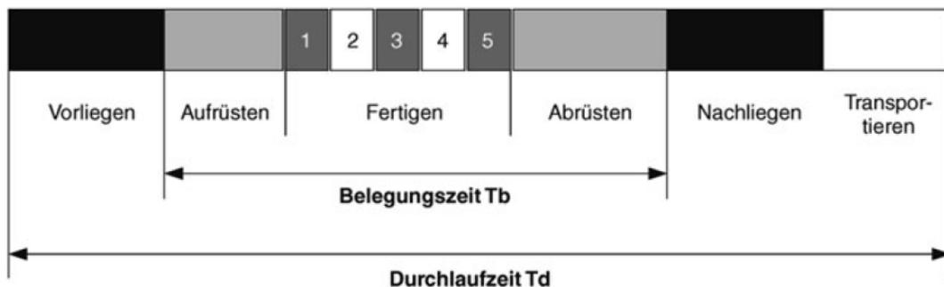
Abb. 5.4: Durchlaufzeitmodell der Fertigung ([Bau14], Seite 31)
