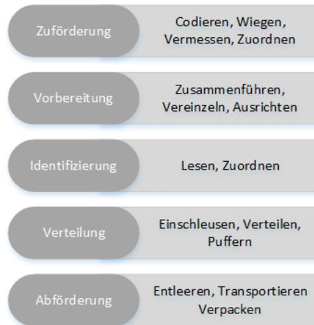
**Abbildung 2: Aufbau eines Sortiersystems, nach ([VDI 3619], S.3)**
