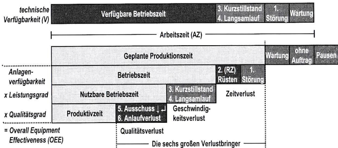
ABBILDUNG 2.3: VERLUSTE IN EINER PRODUKTION UND VERANSCHAULICHUNG DER OEE-KENNZAHL [12]
