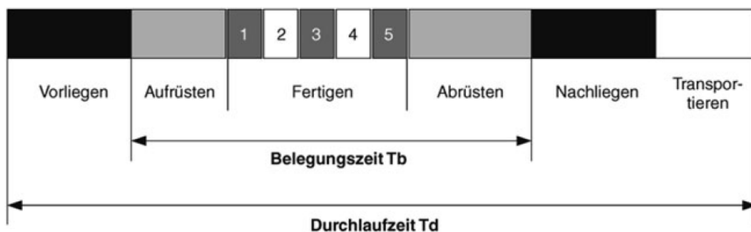
Abb. 5.4: Durchlaufzeitmodell der Fertigung ([Bau14], Seite 31)
