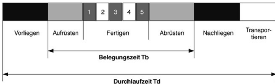
Abb. 5.4: Durchlaufzeitmodell der Fertigung ([Bau14], Seite 31)
