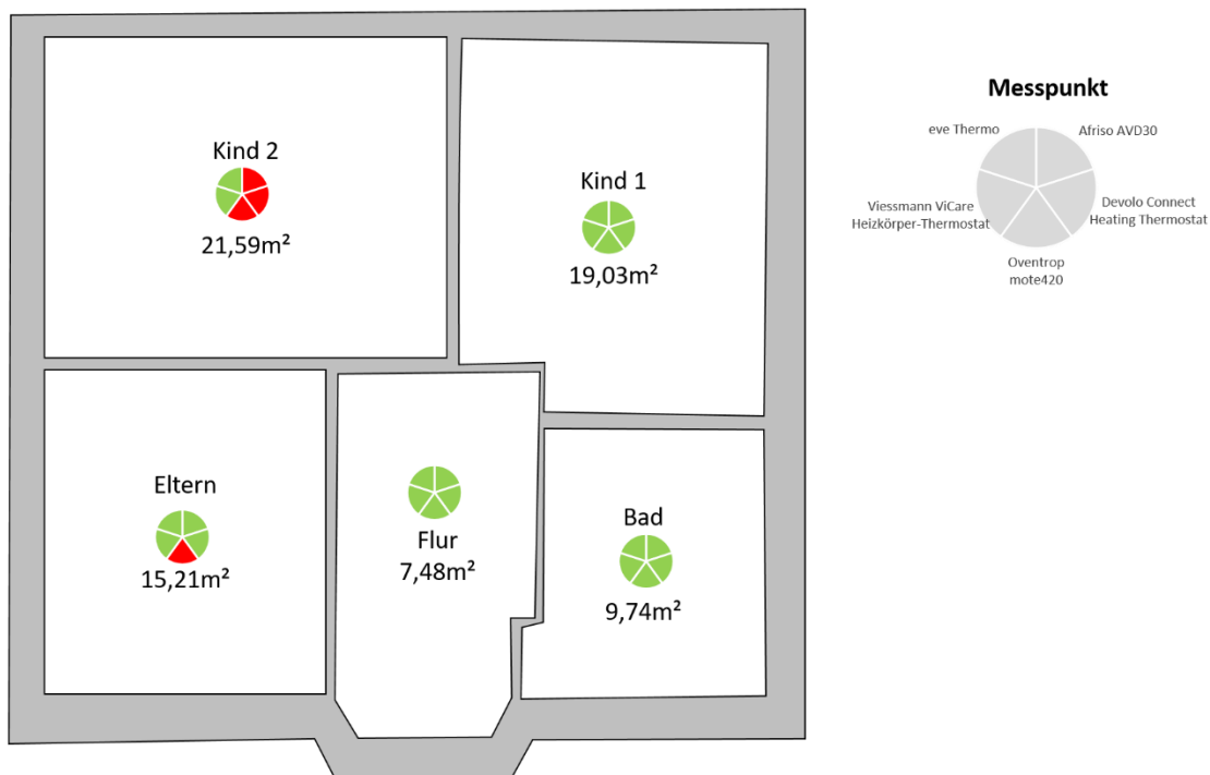
Abbildung 4.1: Ergebnis der Reichweitenmessung im Gebäude bis 200 m 2 Wohnfläche
