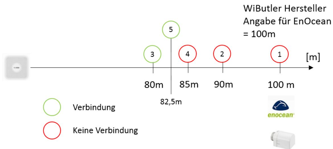
Abbildung 3.7: Beispielhafter Aufbau und Ablauf der Freifeld Funkreichweite. Am Beispiel der H.A. des mote420 von Oventrop
