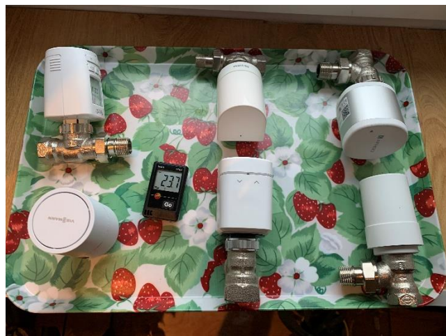
Abbildung 3.13: Anordnung der Stellantriebe und des Referenzmessmittels
