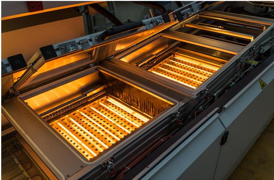
**Abbildung 27: Wellenlötanlage (Ersa)**
