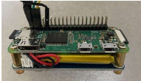
Abbildung 5.17: Waveshare UPS HAT (C) verbaut an einem Raspberry Pi Zero W.
