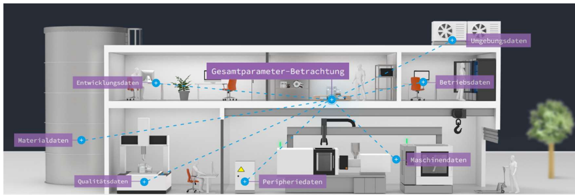
Abbildung 3.2: Prinzipdarstellung möglicher Datenquellen des Detact Systems [11].
