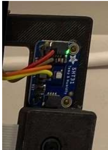
Abbildung 5.4: Sich in Betrieb befindlicher Sensirion SHT31 , aufgeklebt auf Trägerplatte.
