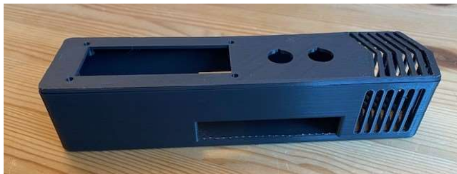
Abbildung 5.18: Leeres Gehäuse der mobilen Terminals aus schwarzem PLA.
