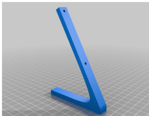
Abbildung 5.7: 3D Modell des Stellfußes. Es sind zwei Stellfüße pro Messstation verbaut [77].
