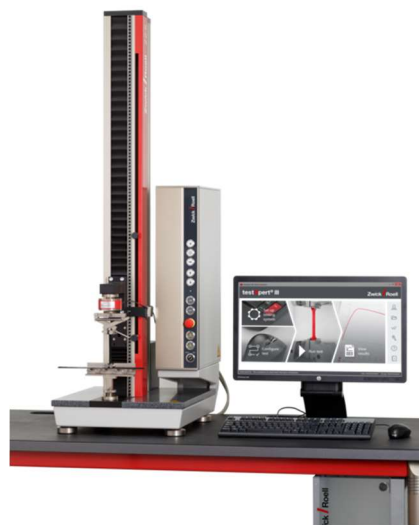
Abbildung 5.25: ZwickiLine Prüfmaschine mit sichtbarer TestExpert III Software auf dem Messrechner [111].
